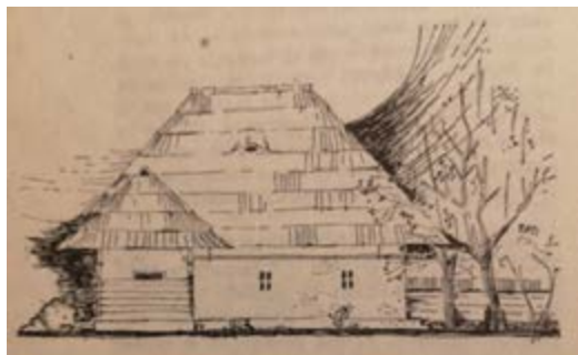
Foto 7. Propunerea de reconstituire a fațadei principale cu introducerea unui foișor caracteristic zonei, ținându-se cont de urmele găsite în teren de la soclul acestuia (Gheorghe Bratiloveanu, Mihai Spănu, Op. cit , p. 34)
